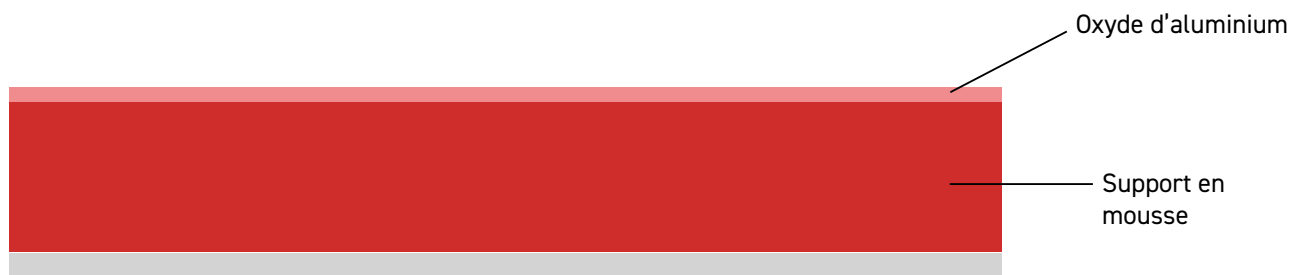
Dessin en 2D de la structure du grain des disques abrasifs WET&DRYFINISH du support en mousse.
