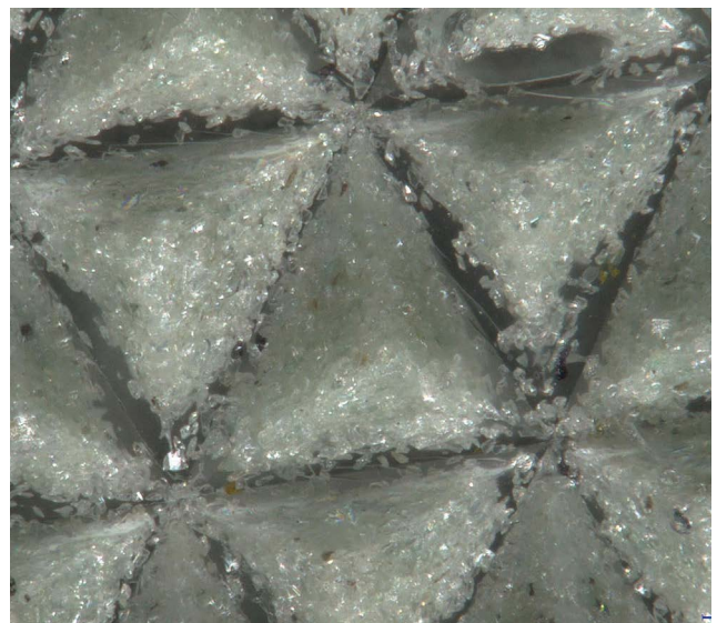
Vista microscópica de la estructura de los granos de los abrasivos MICROFINISH.
