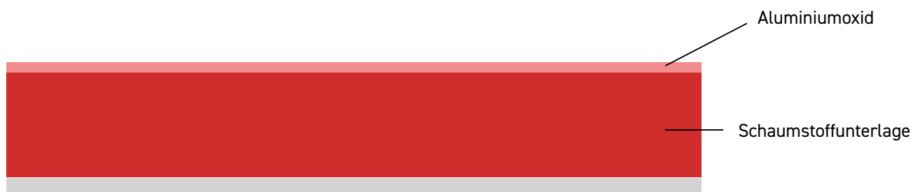
2D-Zeichnung der Kornstruktur der WET&DRYFINISH Schaumstoff-Schleifscheiben.
