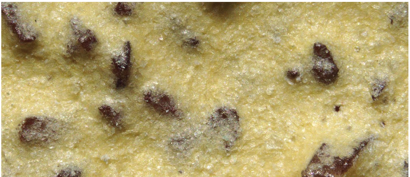
Mikroskopische Ansicht des Kornmusters der MULTIPURPOSE Papierschleifscheiben.
